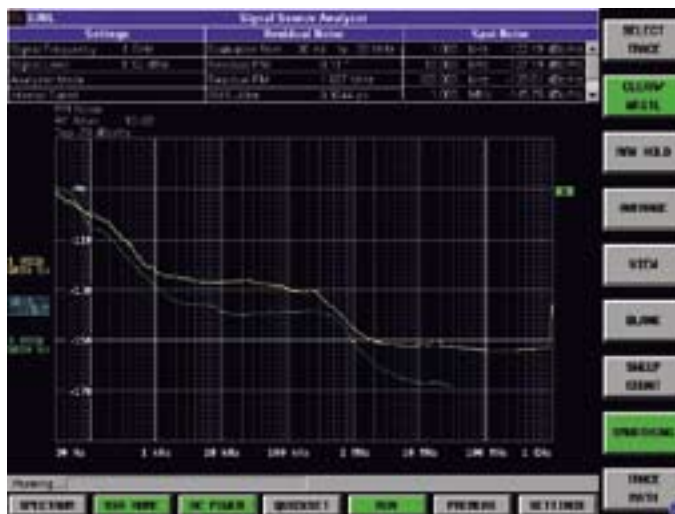
Сравнение измерения фазового шума, выполненного по методу фазового компаратора с перекрестной корреляцией (зеленая кривая), с непосредственным измерением с помощью анализатора спектра (желтая кривая).
